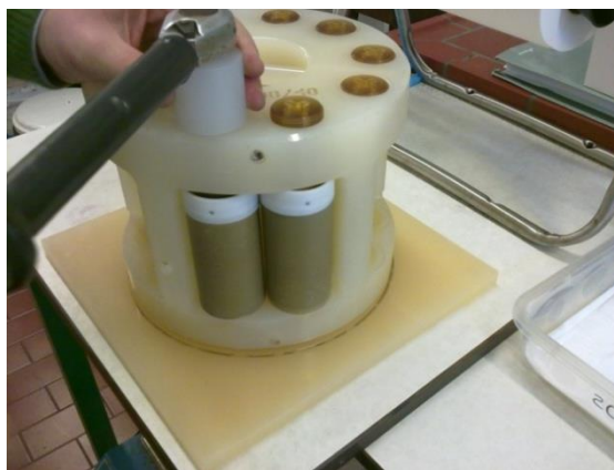
Fig 6.3 - Colocação dos recipientes de digestão no suporte
